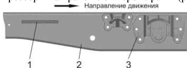
Рис. 1.3. 1 – место нанесения VIN автомобильных шасси для дооборудования коробкой отбора мощности; 2 – лонжерон рамы правый; 3 – передний кронштейн задней рессоры
