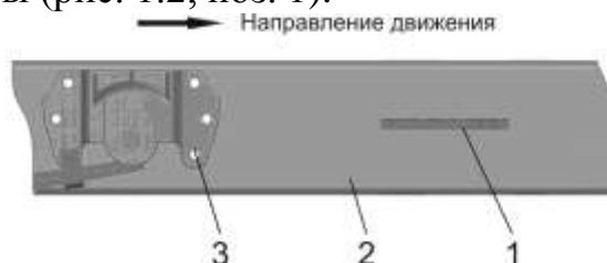
Рис. 1.2. 1 – место нанесения VIN автомобилей с платформой и их шасси; 2 – лонжерон рамы правый; 3 – передний кронштейн задней рессоры
