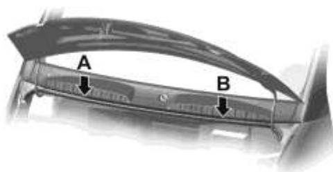
Рис. 1.1. А – место нанесения VIN автомобилей с цельнометаллическим кузовом и их шасси; В – место нанесения идентификационного номера кабины или цельнометаллического кузова
