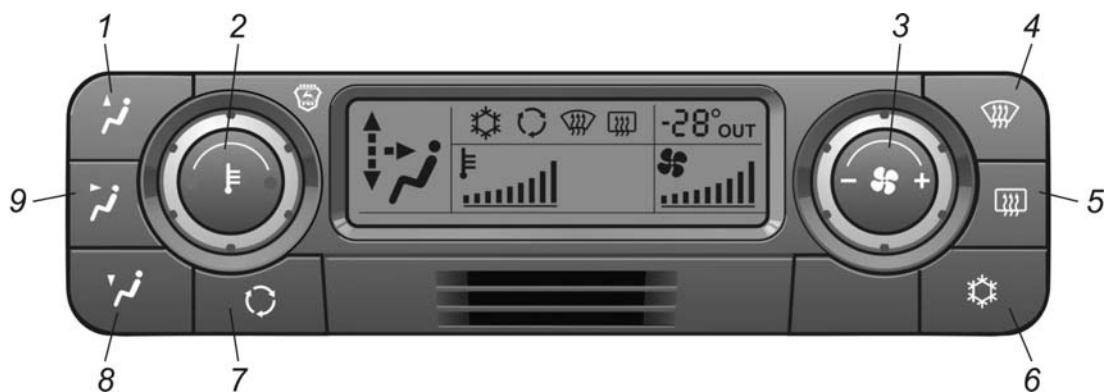
Рис. 8.1. Пульт управления отопительно-вентиляционной и климатической установкой
