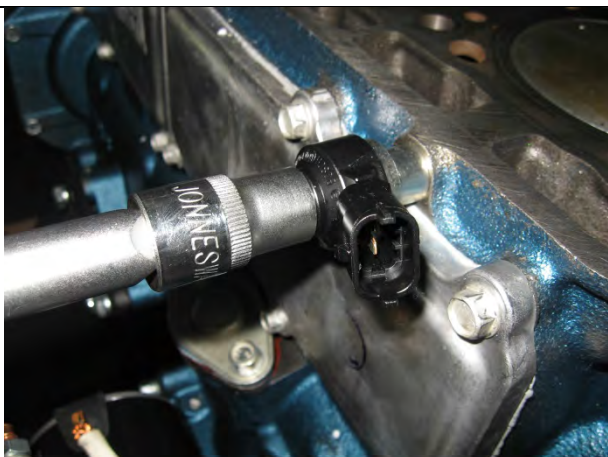
P27. Отвернуть болт крепления датчика детонации, снять датчик. Ключ S13
