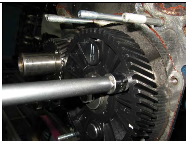
Р50. Отвернуть 2 болта крепления упорного фланца распределительного вала Ключ S12
