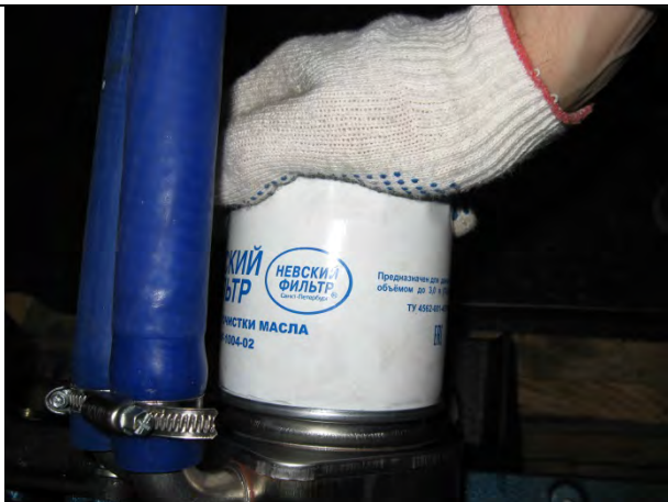
Р31. Отвернуть фильтр очистки масла. См. 3.6 стр.20
