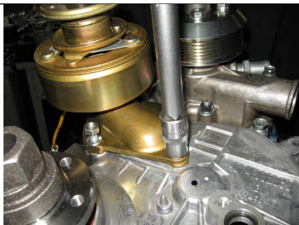
S20. Установить электромагнитную муфту Ключ S=13
