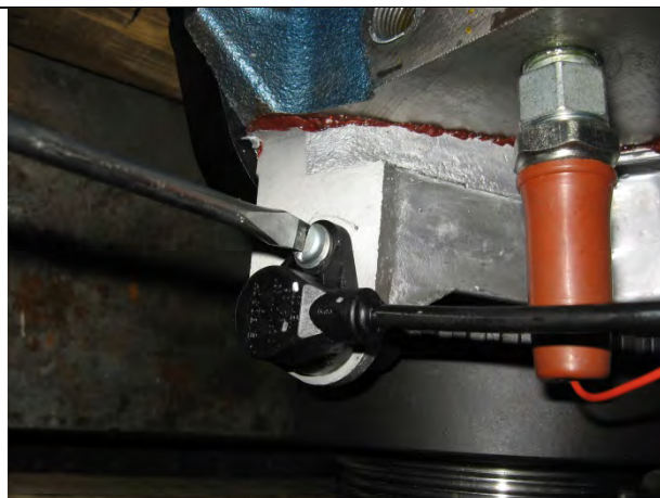
Р36. Отвернуть винт и снять датчик синхронизации. Отвёртка шлицевая.
