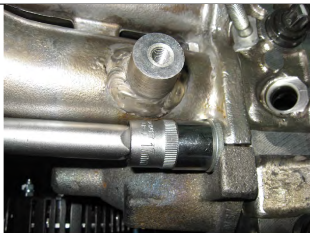
P20. Отвернуть гайки крепления выпускного коллектора и снять его (ключ S=17). Отвернуть гайки крепления впускной трубы и снять её (ключ S=17)
