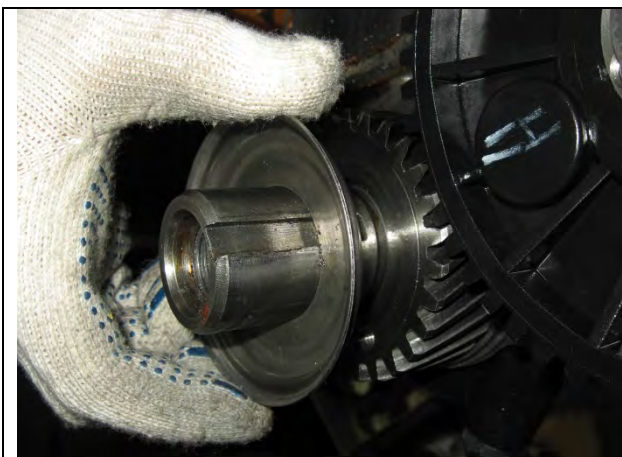
Р49. Снять с коленчатого вала маслоотражательную шайбу.
