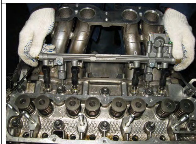
P18. Снять топливный модуль.
