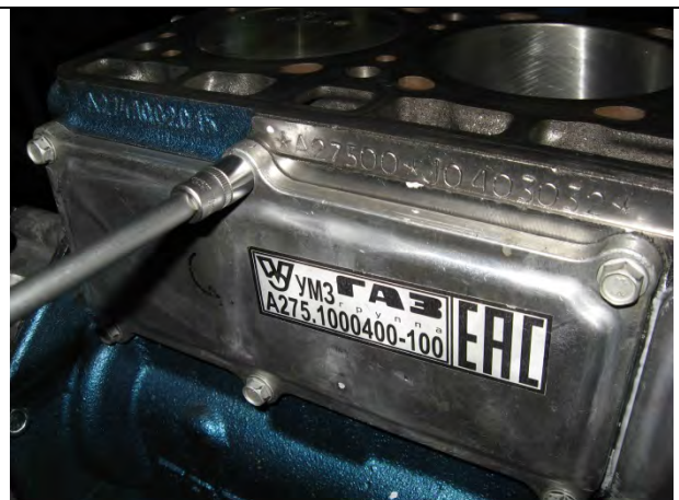
P28. Отвернуть 6 болтов крепления крышки коробки толкателей и снять ее вместе с прокладкой. Снять вторую крышку. Ключ S10.
