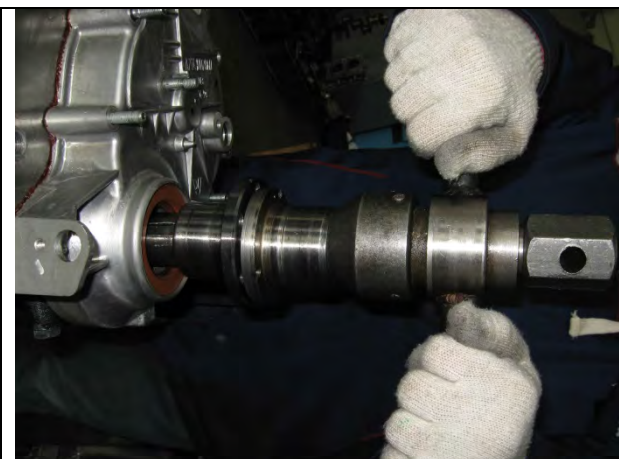
S15. Установить ступицу коленчатого вала. 71-1978 Приспособление для снятия и напрессовки ступицы шкива коленчатого вала и распределительных шестерен.
