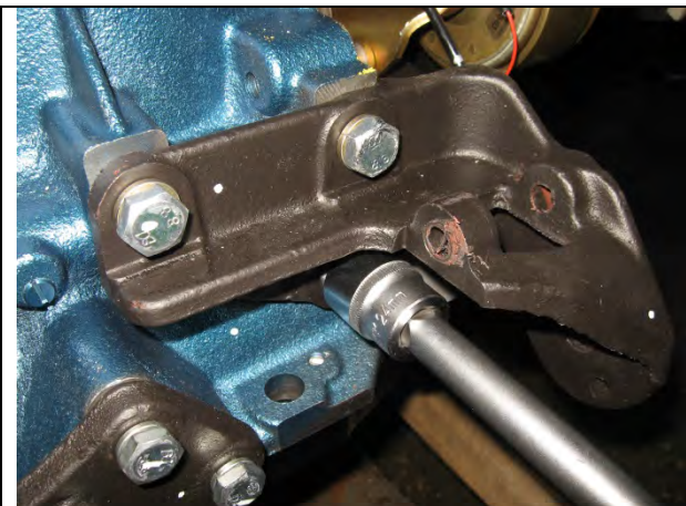
Р33. Отвернуть штуцер масляного радиатора Ключ S24
