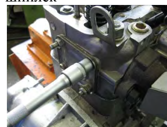
Рисунок 46 – отворачивание крепежа крышки водяной рубашки
