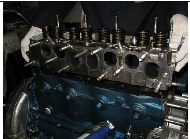
P26. Отвернуть 10 гаек крепления головки блока цилиндров и снять головку блока с прокладкой. Ключ Torx E14
