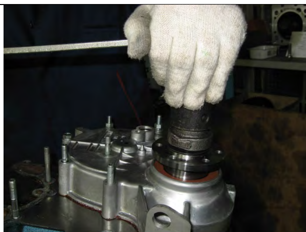
S18 Завернуть болт коленчатого вала. Ключ S=36
