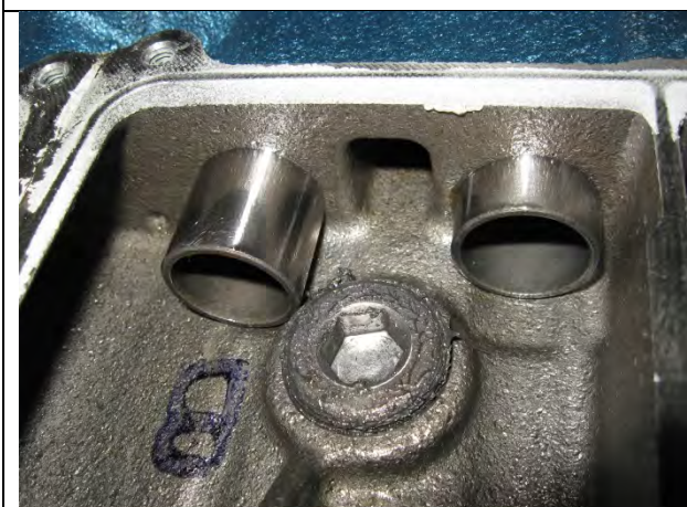
Р51. Вынуть распределительный вал, предварительно утопив толкатели.
