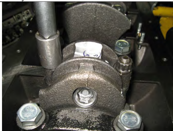
Р53. Отвернуть гайки крепления шатунных крышек коленчатого вала. Накидной ключ S14
