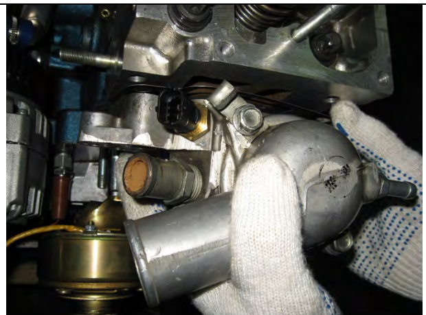
P25. Отвернуть крепление корпуса термостата и снять его вместе с прокладкой. Ключ S14
