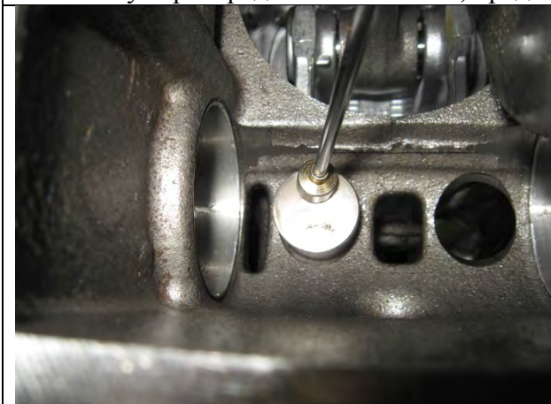
Р52. Вынуть из направляющих гнезд толкатели. Для правильной сборки разобранного двигателя необходимо каждый толкатель отметить номером соответствующего гнезда в блоке.
