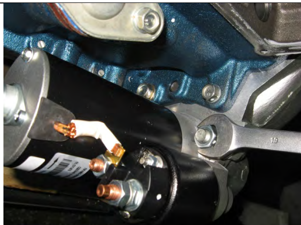
Р37. Отвернуть гайки крепления стартера, снять стартер Ключ S19
