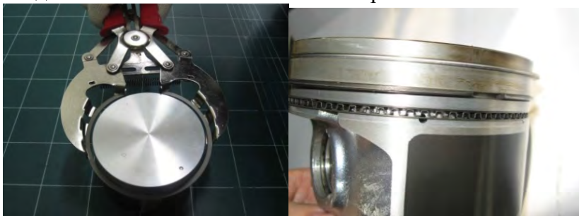
Рисунок 60 – Установка поршневых колец
