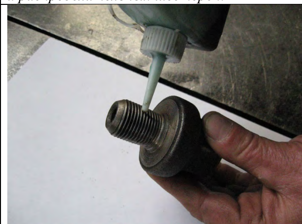
S17. Подобрать болт коленчатого вала с шайбой. Перед установкой болта коленчатого вала нанести на 2...3 витка резьбы в виде замкнутого кольца анаэробный клей-герметик "Loctite-262". Допускается нанесение герметика на резьбу в виде двух продольных полос шириной 2...3мм по всей длине резьбы.
