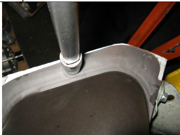
Р38. Отвернуть 4 болта крепления картера сцепления, снять картер сцепления. Ключ S12
