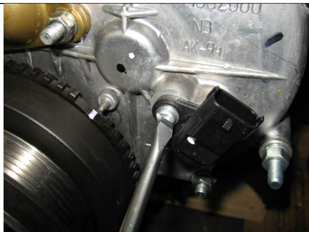
Р35. Отвернуть винт и снять датчик фазы. Отвёртка шлицевая
