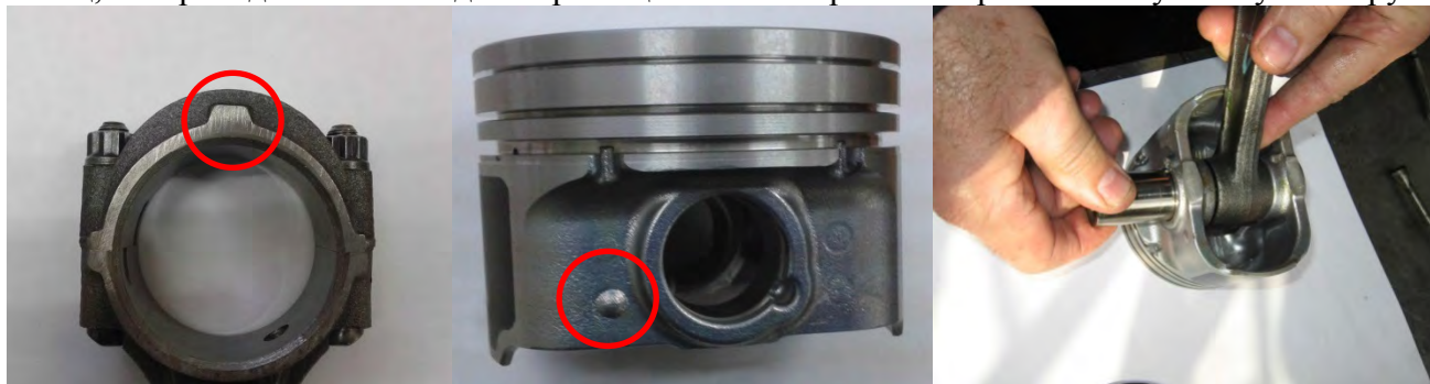
Рисунок 49 – Сборка шатуна с поршнем
