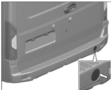
Для доступа к заправочному устройству на автомобилях А31R25, А32R25, А31R35, А32R35 и автобусах А65R35 нажмите на крышку люка, расположенную с правой стороны заднего бампера, в месте, показанном на рисунке.
