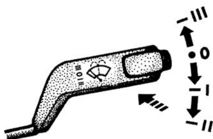
Рис. 5.5. Положения рычага переключателя стеклоочистителя и стеклоомывателя (без звукового сигнала)
