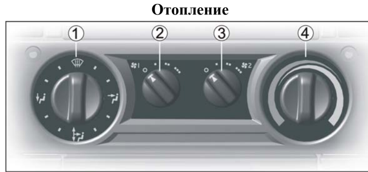
Рис. 8.1. Панель управления отоплением и вентиляцией:
