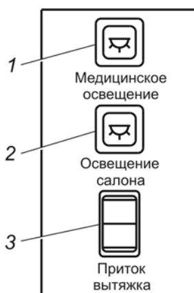
Рис. 8.1.38. Панель органов управления освещением и вентиляцией медицинского салона: 1 – выключатель медицинского освещения; 2 – выключатель освещения салона; 3 – переключатель фильтро-вентиляционной установки
