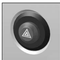
Рис. 2.8. Кнопка выключателя аварийной сигнализации
