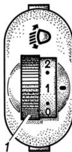
Рис. 2.2. Корректор фар: 1 – маховичок блока
