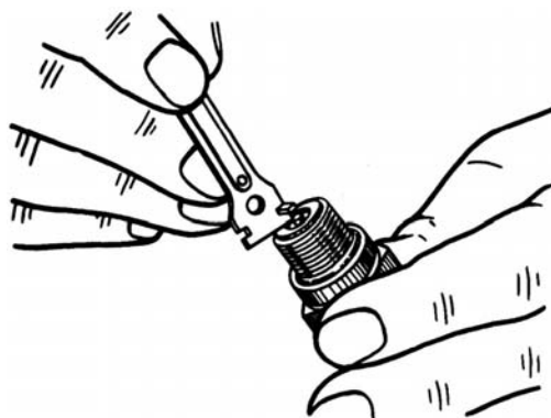
Рис. 8.1.31. Регулировка искрового зазора в свече зажигания
