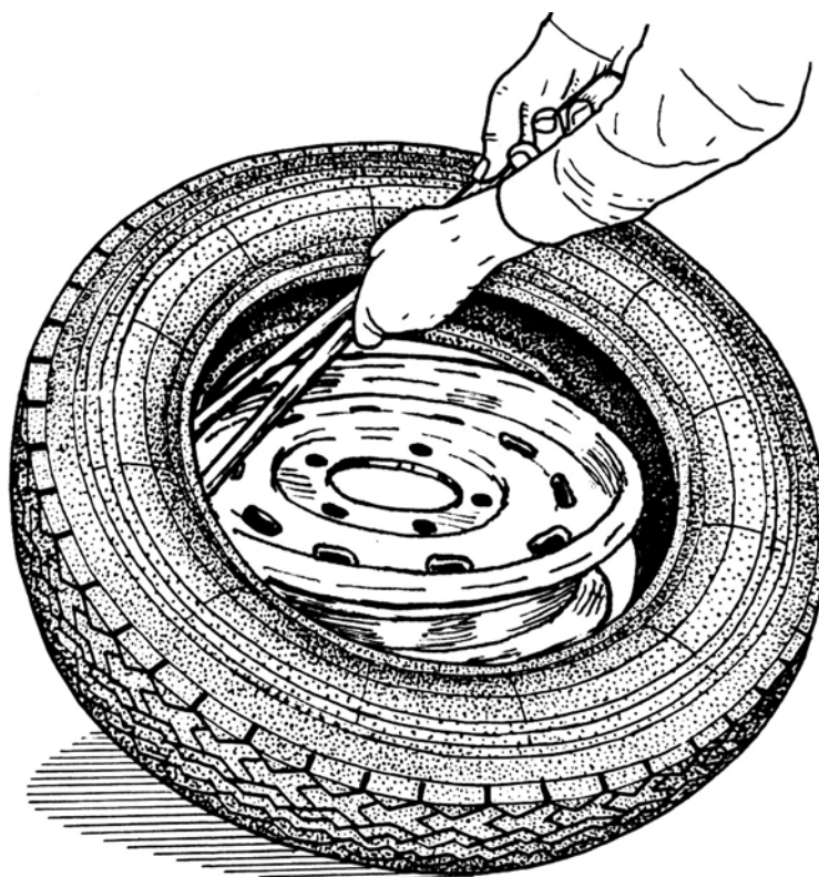
Рис. 5.19. Надевание борта шины на обод
