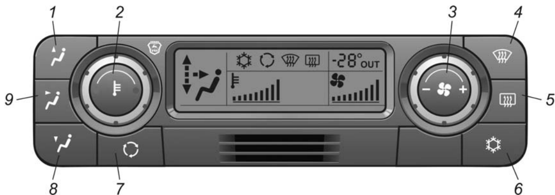
Рис. 8.1. Пульт управления отопительно-вентиляционной и климатической установкой
