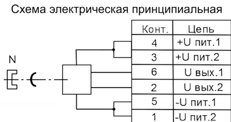
Рис. 7.75. Схема электрическая модуля педали акселератора
