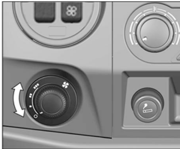
Рис. 7.41. Установка переключателя дополнительного отопителя
