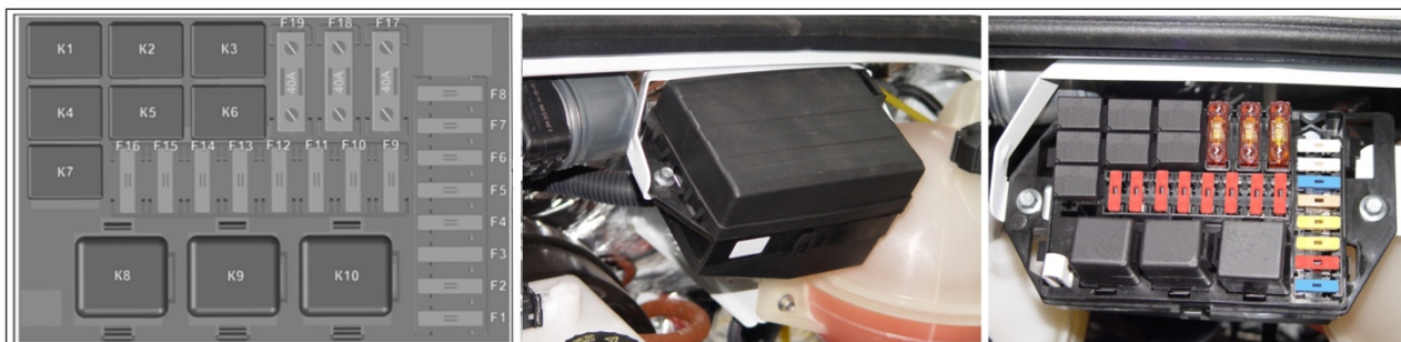
Рис. 7.68. Установка блока реле и предохранителей, расположенного в моторном отделении
