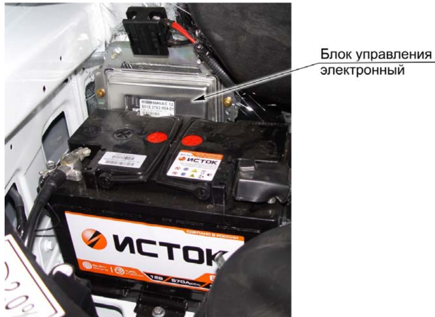
Рис. 7.72. Установка электронного блока управления МИКАС М12
