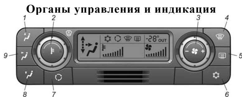
Рис. 8.1. Пульт управления отопительно-вентиляционной и климатической установкой
