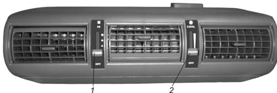
Рис. 8.5. Управление задним охладителем автомобилей ГАЗ-22171, ГАЗ-22174 и ГАЗ-221717:
